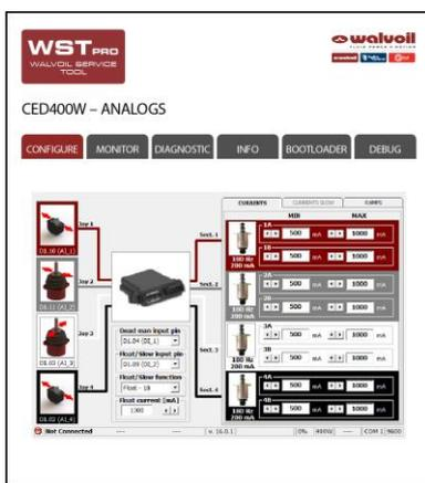
Il nuovo WST-pro può essere collegato a tutti i componenti elettronici Walvoil ed integra in un solo ambiente i più usati strumenti di service (bootloader, configuratore, diagnostica).
